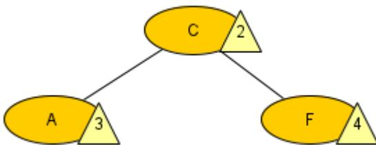
Diesmal muss der KNOTEN sich selbst zuerst nennen, da er eingefügt werden muss, bevor man seine Nachfolger einfügen kann. Deswegen kommt er selber zuerst und dann die beiden Nachfolger links und rechts.
