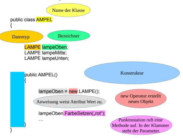
In einer Klasse werden immer zuerst die Attribute deklariert. Danach folgt der Konstruktor/die Konstruktoren.
